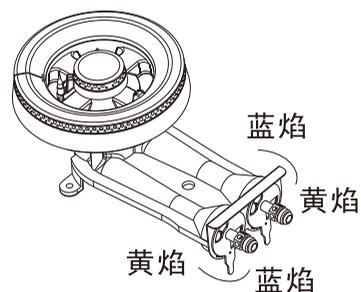
调节方式：将调节手柄轻轻向外扳置后，旋转手柄直至火焰正常燃烧，再将手柄置入对应的卡槽内限位。
