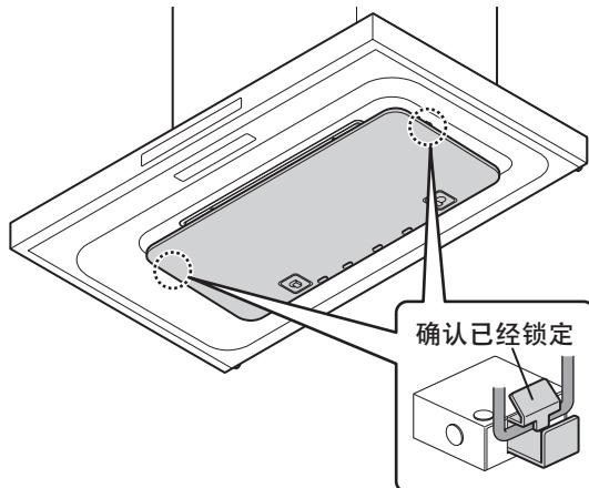
12) 将油杯安装在整流板上。
