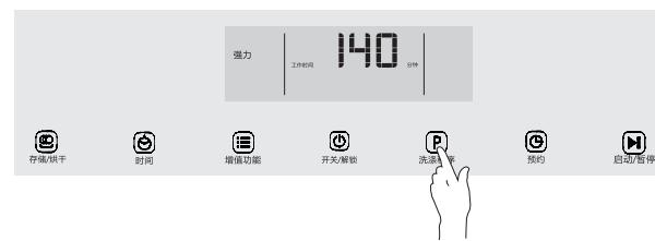
3. 当选择好洗涤程序后，按启动“”键，10秒内无其他操作洗碗机进入工作状态，工作结束后自动关机。
