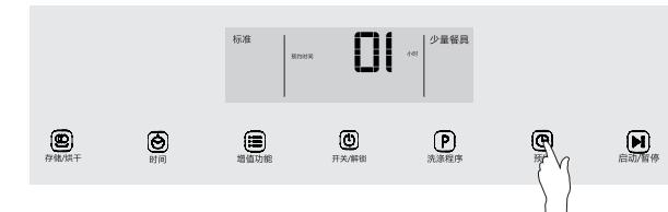
8. 当用户觉得有必要时, 可以选择存储/烘干程序对干净的餐具进行烘干或存储, 按存储/烘干" "按键一次, 显示屏会显示存储, 按该按键两次, 显示屏会显示烘干, 选定所需的程序后, 设置好后按启动按键, 10秒内无其他操作, 洗碗机进入工作状态, 工作结束后自动关机。
