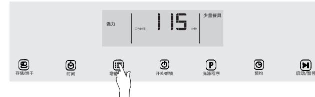
7. 在设定好洗涤程序后, 用户可以选择预约功能设定到自己想要的时间让洗碗机进行工作, 按预约" "按键, 显示屏会显示01h, 然后每按一次增加1H, 预约时间可在01-12h反复循环变化, 设置好后按启动按键, 10秒内无其他操作, 显示屏显示对应洗涤功能和时间倒计时。
