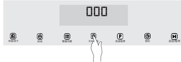
2. 按洗涤程序“”按键，显示屏会显示相应的洗涤程序，每按一次，会切换一次不同的洗涤程序，用户根据需求选择适合您的程序进行洗涤餐具。
