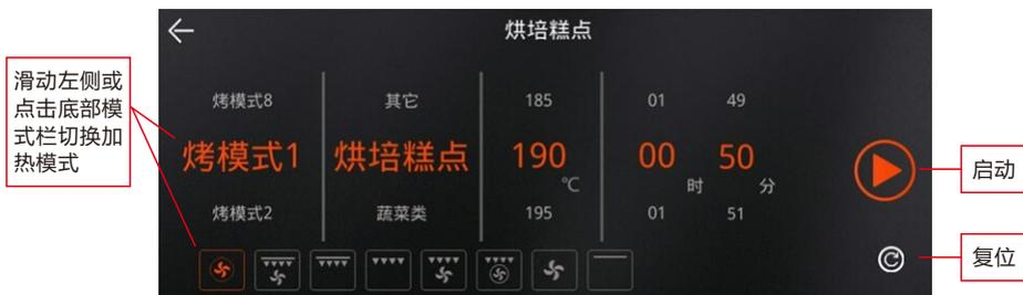
提供8类加热的烤模式，包括常用的顶加热、风扇烤、风焙烤等
