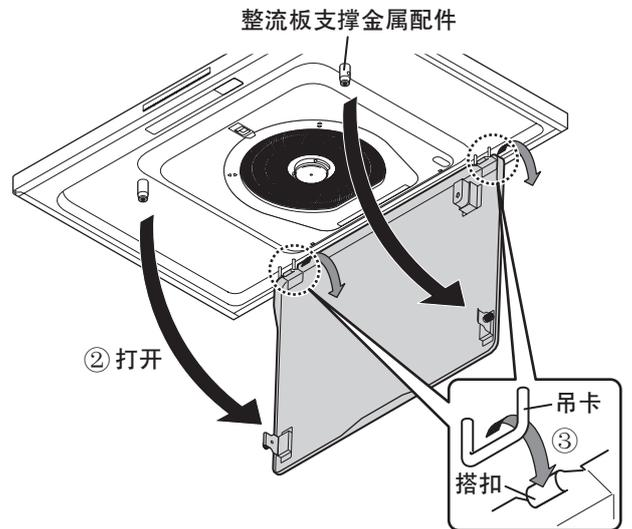
3) 在右下图所示位置举起整流板后端，从吸油烟机吊环部卸下 (③)。
