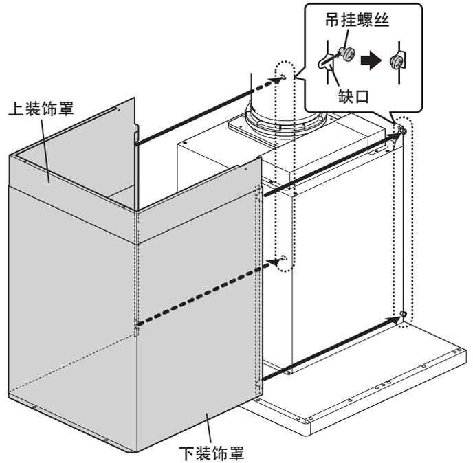
10) 以平头螺丝（M4×10）2个将下装饰罩前侧下部固定在机体上。
