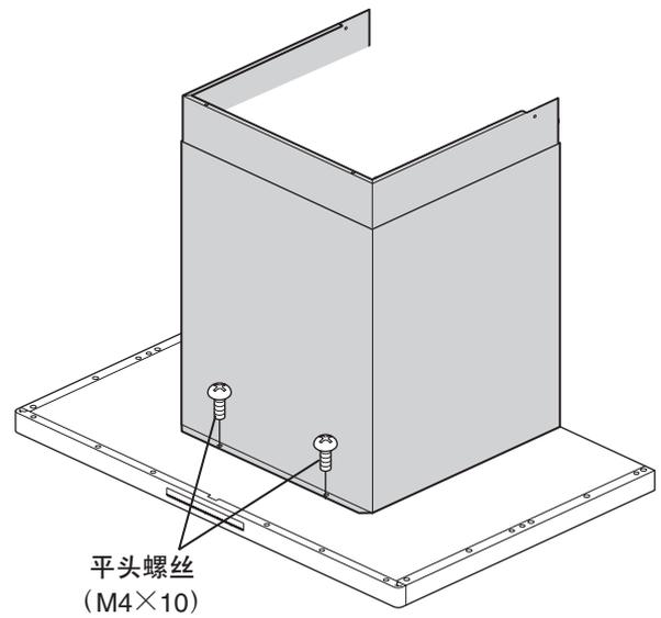
11) 将上装饰罩内侧滑动部拉伸至吊顶，以平头螺丝（M4×8）2个将其固定在上装饰罩固定支架件上。
