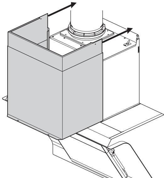
10) 以平头螺丝 (M4×10) 2个将下装饰罩前侧下部固定在机体上。
