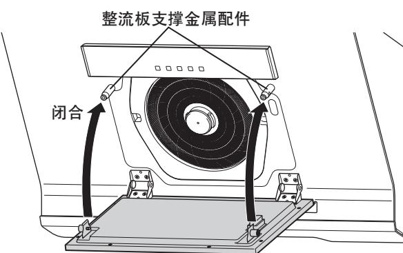
2) 用十字螺丝刀等拧紧整流板固定螺丝、将其固定。
