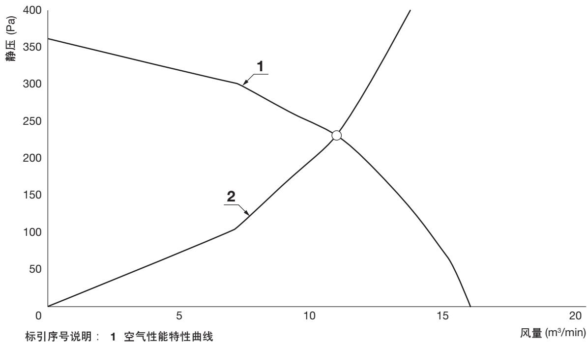
注：空气性能特性曲线与排烟阻力曲线的交点所对应的风量即为工作风量。
